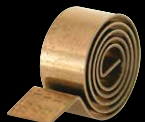
Eine Bimetallfeder, die Verbrennungsluft im Inneren des Kaminofens automatisch regelt, gehört bei allen HWAM Kaminöfen sowie Einbauöfen zur Standardausstattung.
